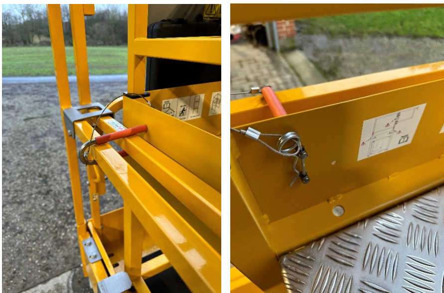
Figur 3 - Placering af U-bøjler og R-clips
