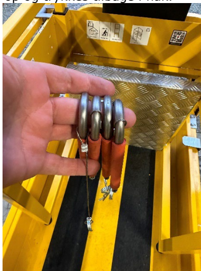
Figur 2 - U-bøjler holdes i hånden
