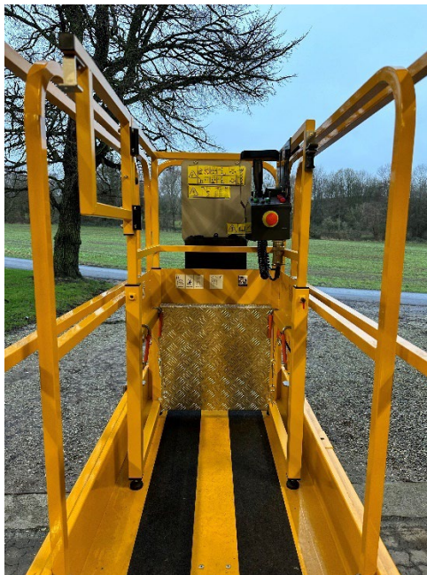
Figur 1 - StepUp placeret på saxliftens udskudsdæk
